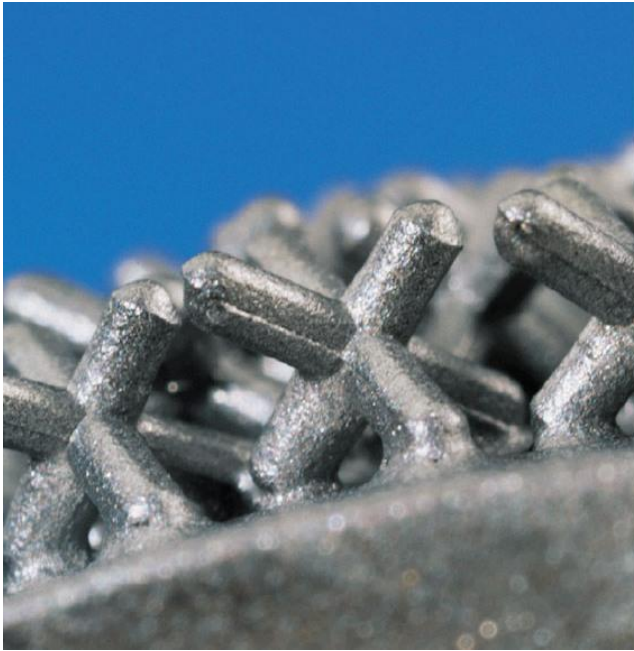
Abb. 14. Tripodenoberfläche in 15-facher Vergrößerung
